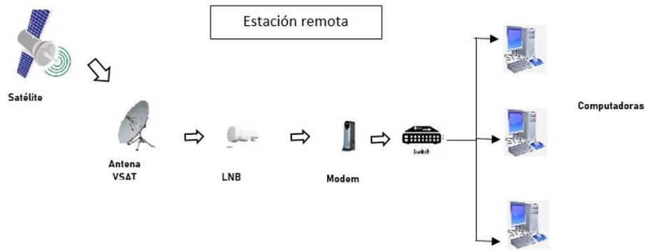
**Figura 3.3:** *Diseño final de la red satelital.*
