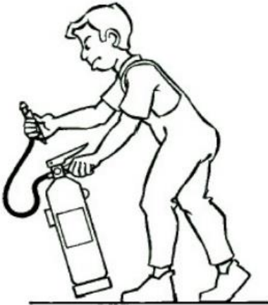
Figura 20: Sujetar de boquilla de la manguera para evitar salida de polvo extintor. imagen Adaptada de la Nota Técnica de Prevención 536 “Extintores de incendio portátiles: utilización” redactado por Adolfo Pérez.
