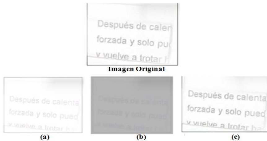
Figura 13. Normalización de la imagen en Open CV con: a) Alpha 150 y Beta 180, b). Alpha 150 y Beta 255 y c) Alpha 2 y Beta 255
