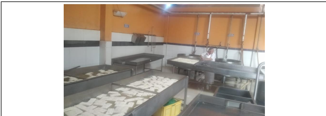
Las superficies en contacto con el alimento en el proceso son de acero inoxidable, lisas e impermeables; facilitando la limpieza y evitando contaminación
