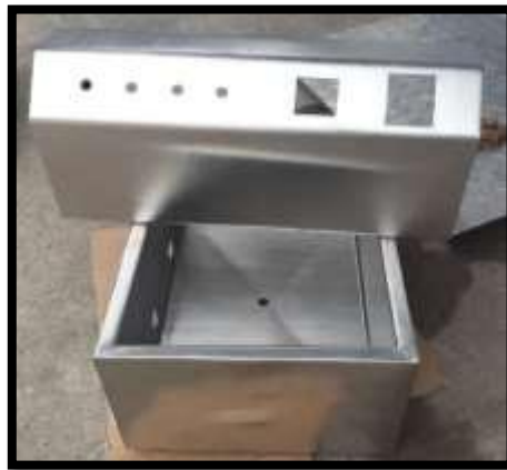
Figura No 16. Partes de la estructura del Baño María
