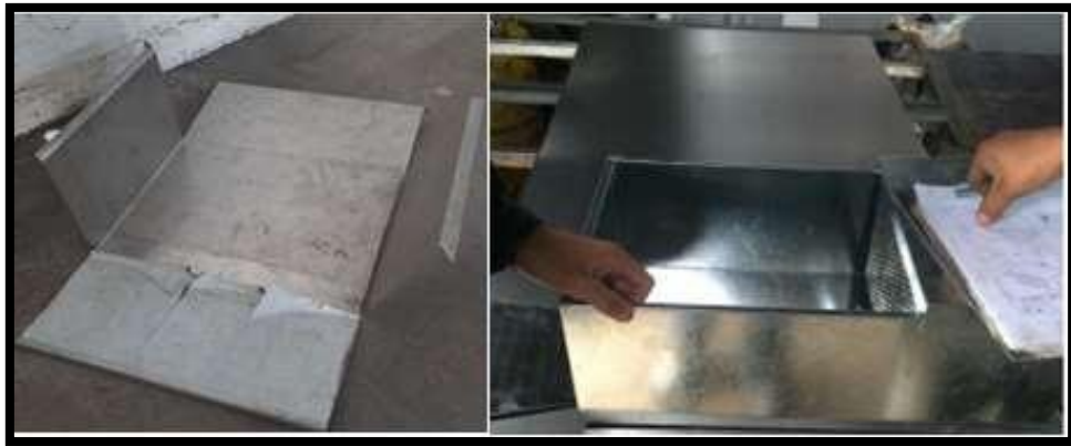
Figura No 15. Construcción del Baño María
