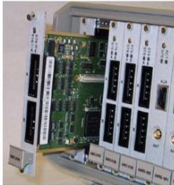
Figura. 3.6 Módulo de Interface de Comunicaciones.<sup>18</sup>Figura.3.7: Ensamblaje de módulos<sup>19</sup>
