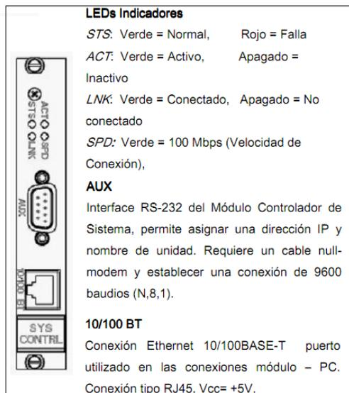
**Figura. 3.4: Módulo de Control del Sistema.<sup>16</sup>**
