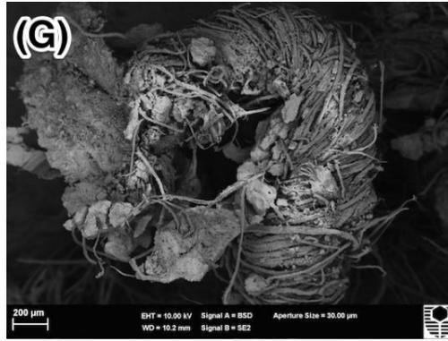
Figura 74: *Imágenes SEM de la superficie de fractura de compuestos NFRG con tejidos de lino (A) puro, (B) 2,4 (C) 3 y (DH) 4,1% en peso; (E y F) adhesión entre la fibra y la matriz, (G) penetración de la matriz en los tejidos de lino, el puente de fibras (D) y (H)*
