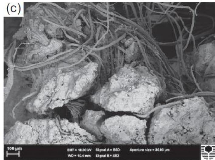
Figura 89: Imágenes SEM de la superficie de fractura de compuestos NFRG con contenidos variables de tejidos de lino (a) fibra desunida en EGPF-1, (b) huella de fibra y extracción en EGPF-2 y (c) grietas puente de fibra EGPF-3.
