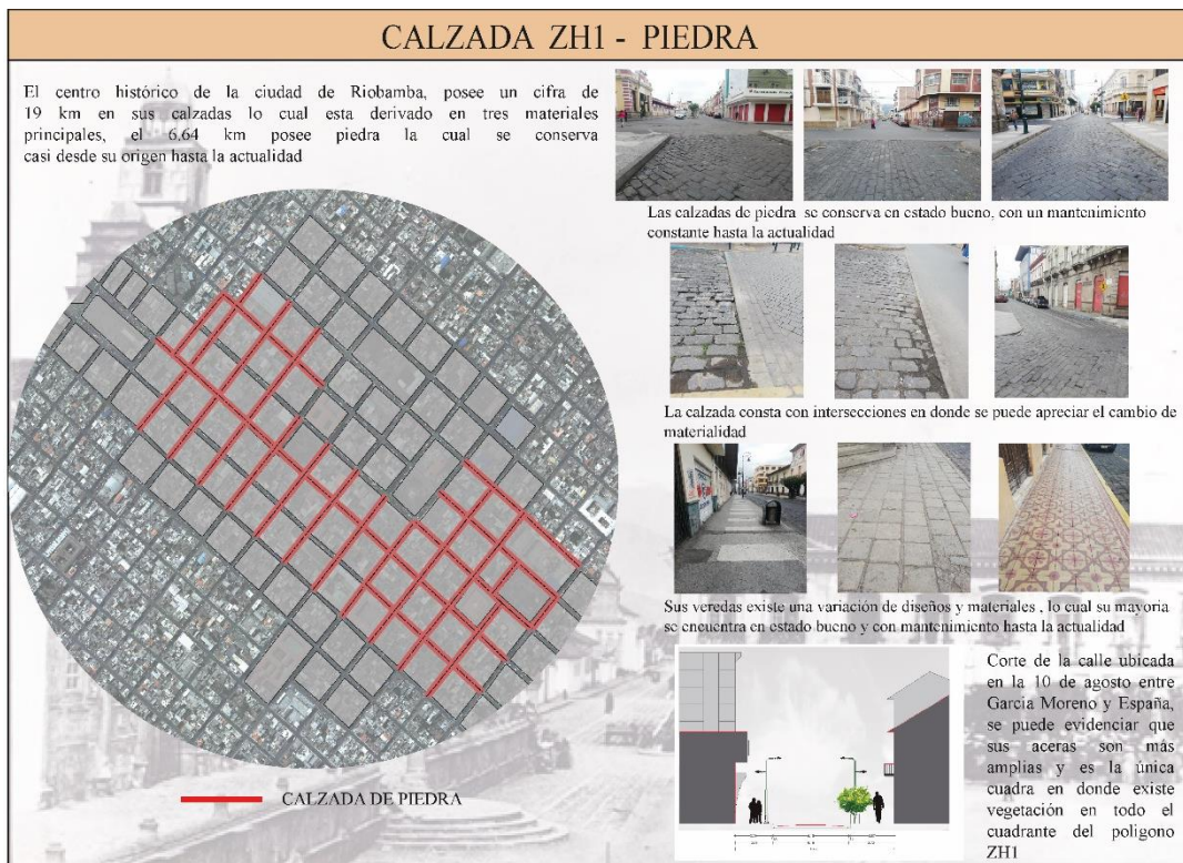
Ilustración 49 Calzada de piedra Silliar
