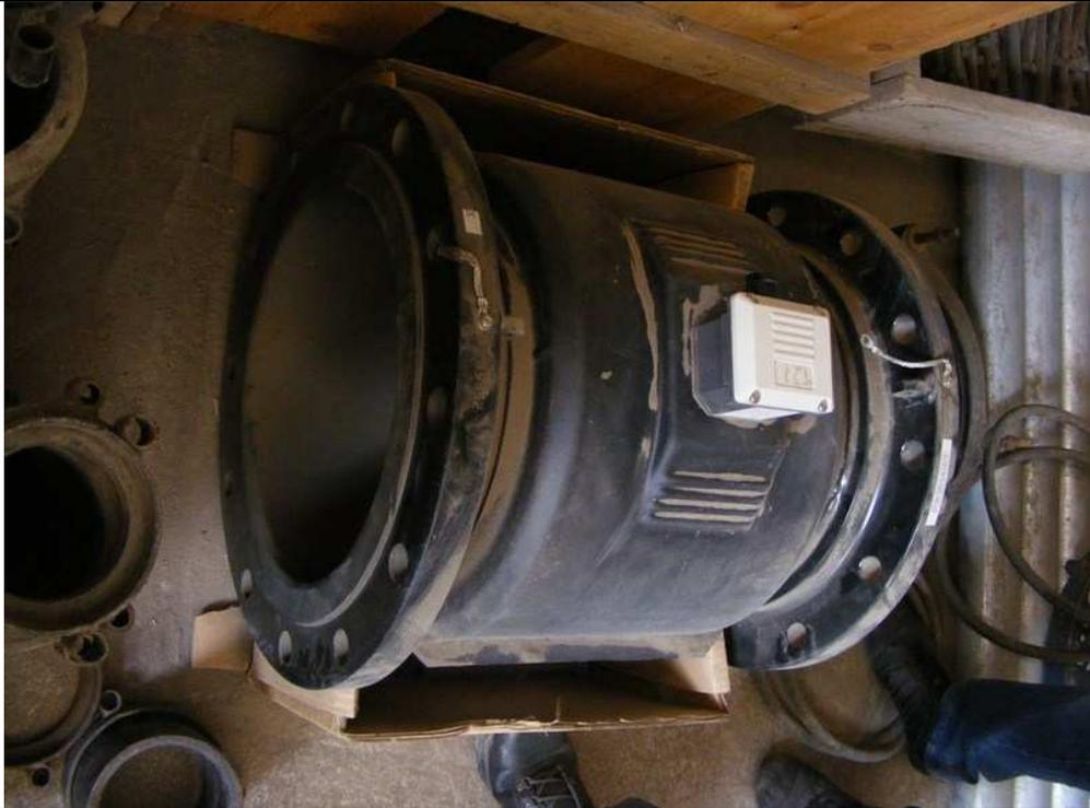
**Fotografía 9.** Caudalímetro Electromagnético
