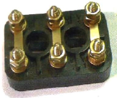
**Figura 29.** Bornera de motor trifásico
