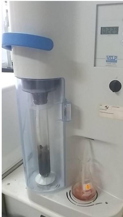
**Ilustración 2** Destilación para proteína
