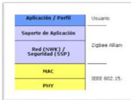
**Figura 9.** Capas del protocolo Zigbee
