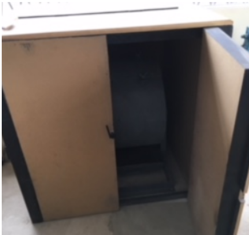
Ilustración 3.7.3- Cabina de insonorización.
