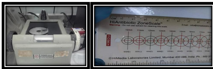
Grafico Nro. 11. Medición de halos inhibitorios con regla y antibiotic zone reader
