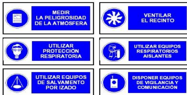
Fig. 3. Señalización de advertencia en trabajos en espacios confinados.
