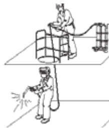
Fig. 6. Botellas de gases de soldadura ubicados en la parte exterior del espacio confinado.
