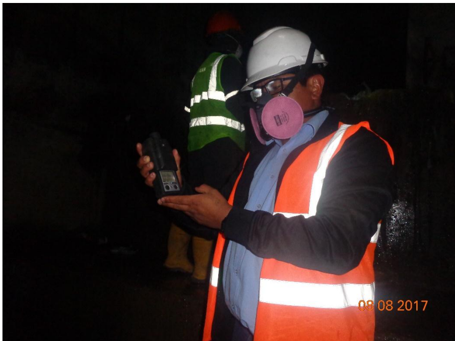
Fotografía N.3.11. Prueba atmosférica estratificada.
