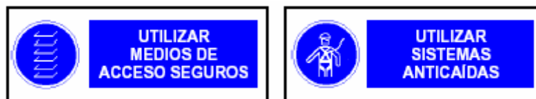
Fig. 4. Señalización de obligación en trabajos en espacios confinados.
