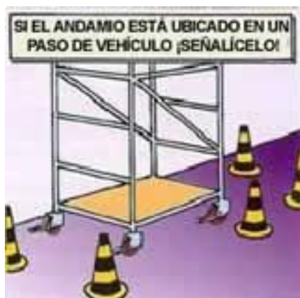
Gráfico 3.42 Señalización de andamio
