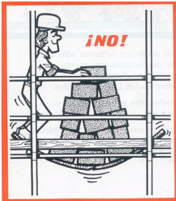
Gráfico 3.39 Inadecuada forma de colocación de carga
