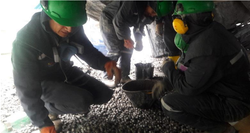
Colocación de Cuerpos Moledores en Balde para Transportarlos
