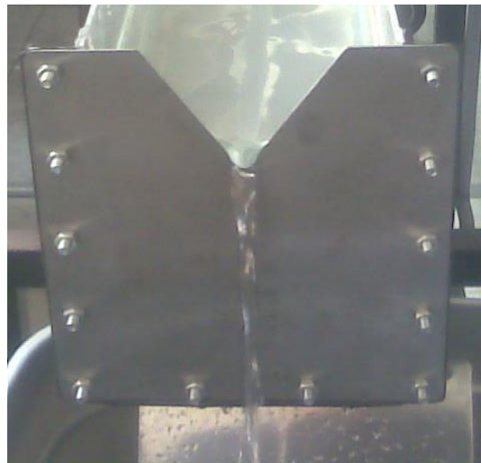
Figura 34. Fotografía de caudal en vertedor Triangular observados en la Práctica.
