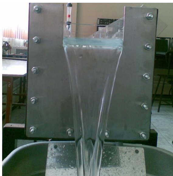
Figura 32. Fotografía de caudal en vertedor Rectangular observados en la Práctica.
