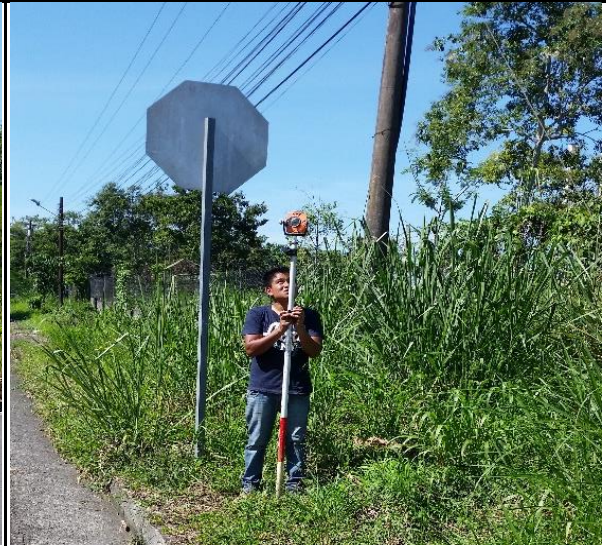
Toma de puntos topográficos en la vía
