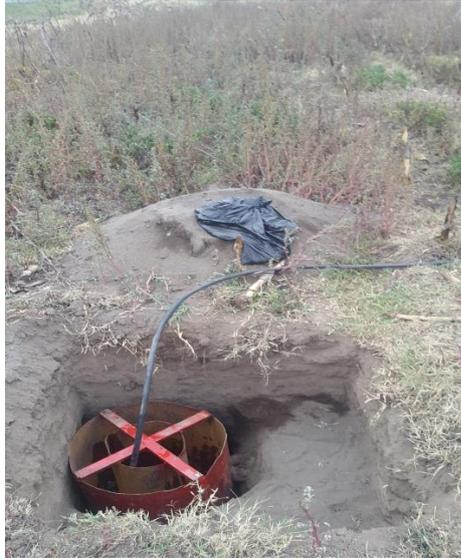
**FOTOGRAFIA 2** Ensayo de infiltración
