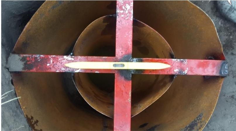
Nivelación del infiltrómetro doble
