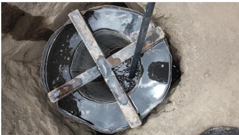
Llenado del Infiltrómetro luego de la Saturación
