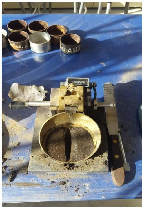
División en dos partes del material colocada en la copa.
