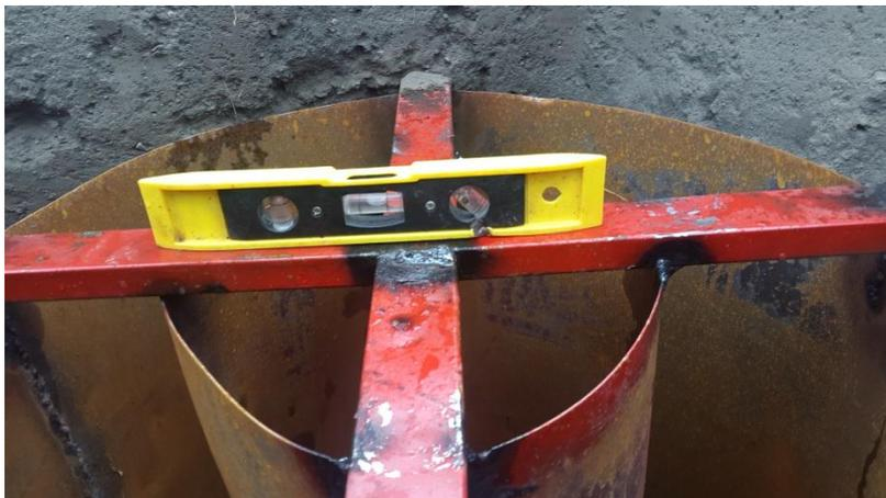
Nivelación del infiltrómetro doble
