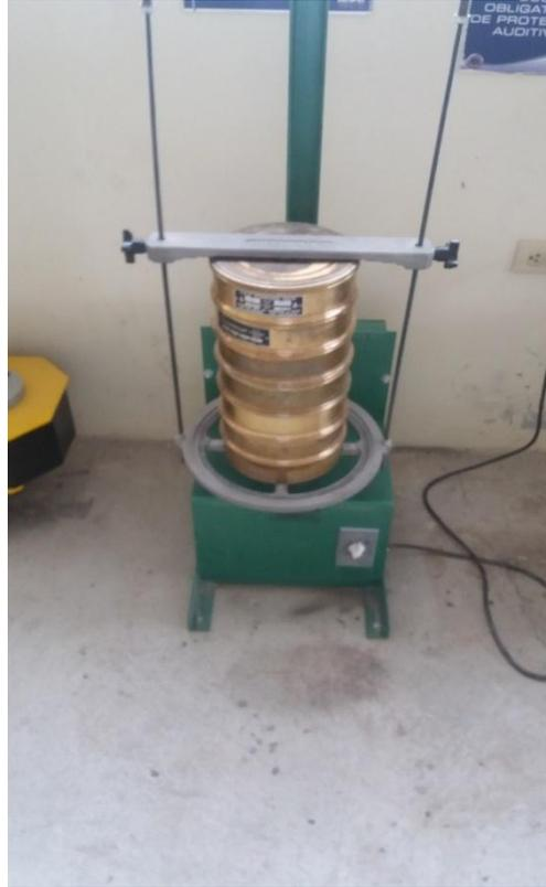
Colocación de los tamices en la tamizadora eléctrica.
