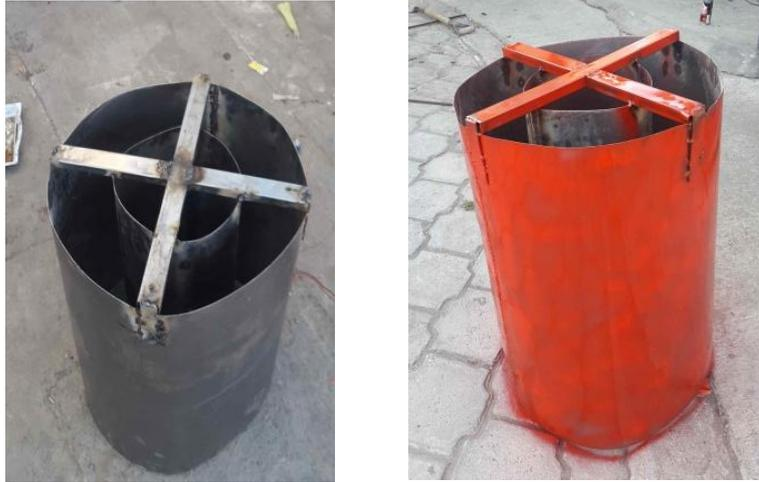
Fotografía 1 Infiltrómetro de cilindro doble
