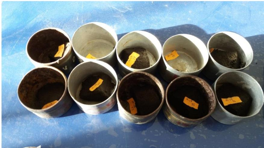
Muestras después del Proceso de Secado.
