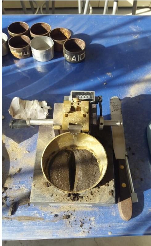
División en dos partes del material colocada en la copa.
