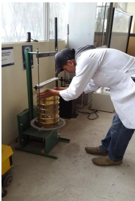
**FOTOGRAFIA 3** Ensayo de Granulometría
