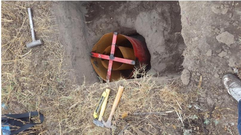
Ubicación del infiltrómetro doble
