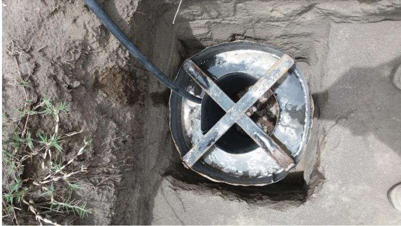
Llenado del Infiltrómetro luego de la Saturación
