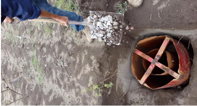
Colocación de Grava en la base del Infiltrómetro Doble
