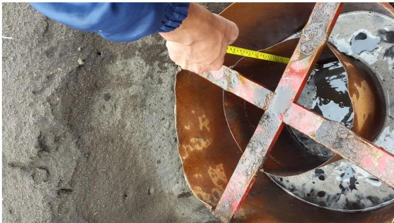
Toma de datos de Infiltración
