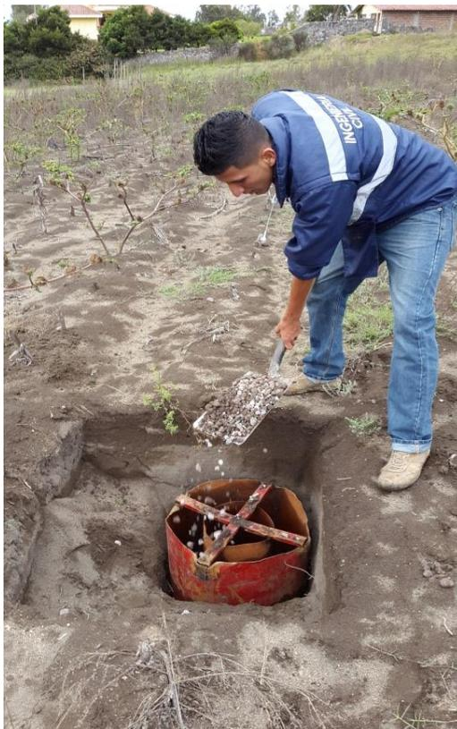
Colocación de Grava en la base del Infiltrómetro Doble
