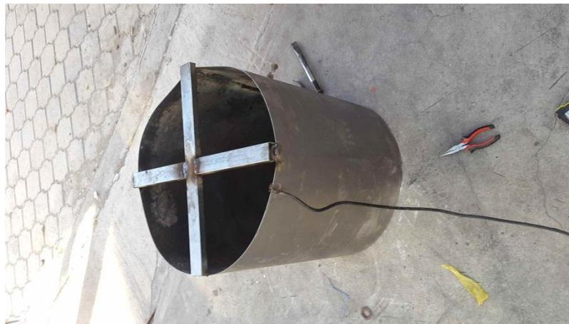
Armado de Infiltrómetros doble
