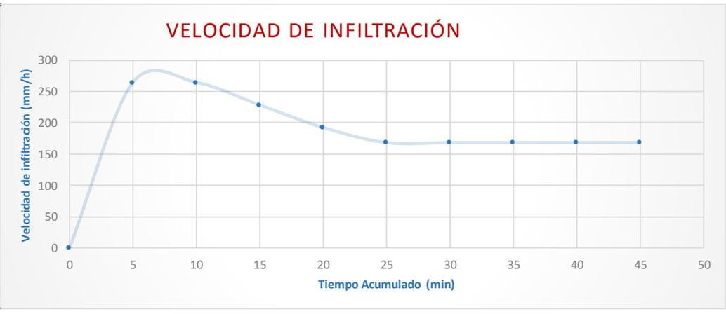
**VELOCIDAD DE INFILTRACIÓN**
