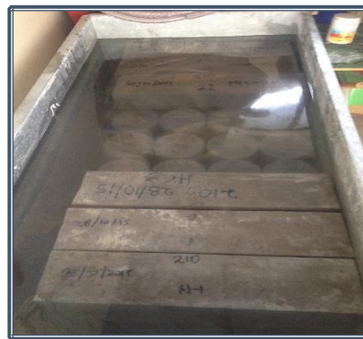
Fotografía 8.22: Curado de cilindros y vigas de hormigón con y sin FRN
