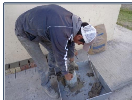
Fotografía 8.54: Control de asentamiento en hormigón fresco
