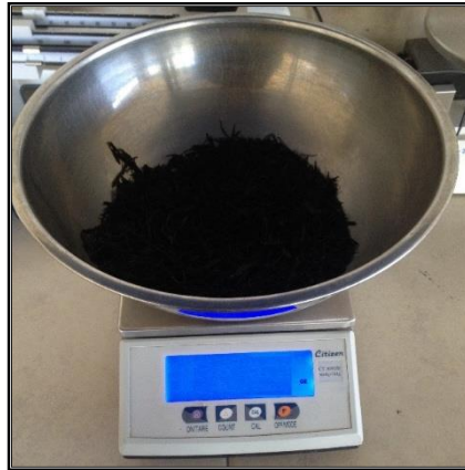
Figura 41. Peso de las fibrillas recicladas de neumático en seco
