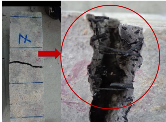
Figura 75. Ensayos realizados, izquierda hormigón convencional, derecho hormigón modificado
