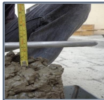
Fotografía 6.6: Asentamiento del hormigón convencional 4,5 cm
