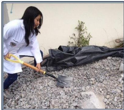
Fotografía 8.9: Recaudación de muestras para contenido de humedad (agregado grueso)
