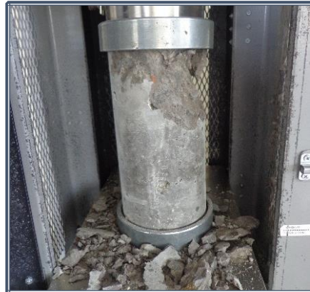
Fotografía 8.86: Falla tipo V en cilindros
