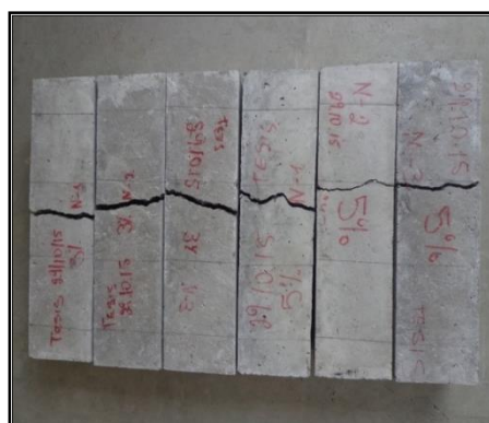
Figura 35. Representación de las fallas de los ensayos a flexión
