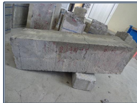
Fotografía 8.78: Fisura de falla en hormigón modificado
