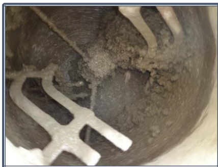
Fotografía 6.5: Amasado del hormigón simple
