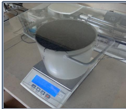
Fotografía 6.2: Masa de la FRN para obtener el peso volumétrico
