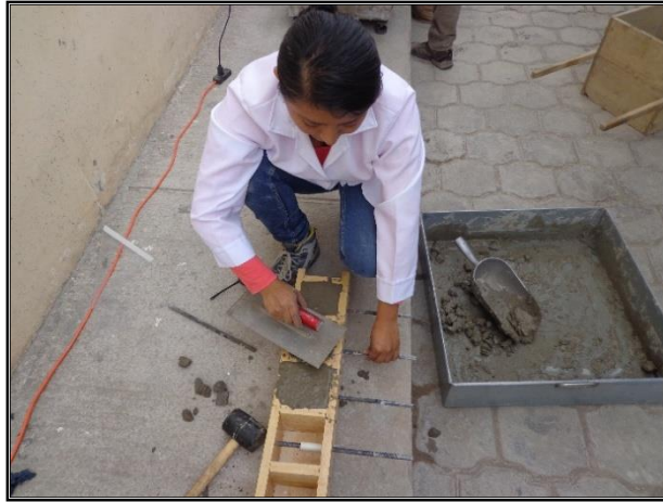
Figura 46. Rasanteo de la probeta para acabado final de la misma
