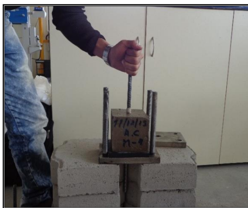
Figura 51. Ubicación de la probeta prismática sobre el prototipo para medir la adherencia
