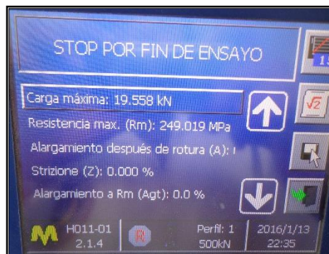
Figura 58. Fin del ensayo de adherencia, y registro del esfuerzo de adherencia a los 28 días, hormigón modificado.
