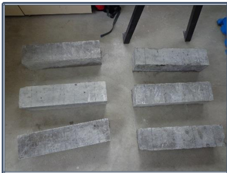
Fotografía 8.75: Vigas enteras listas para dimensionar en tres partes iguales
