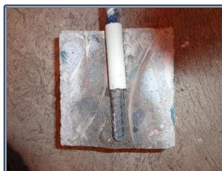
Fotografía 8.70: Probeta fallada y recortada por la mita en hormigón convencional
