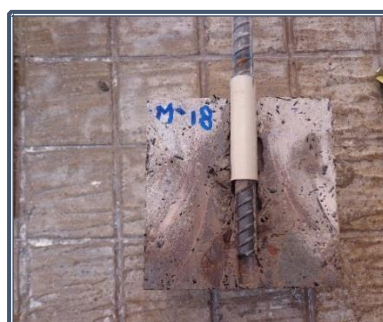
Fotografía 8.72: Probeta fallada y recortada por la mita en hormigón modificado
