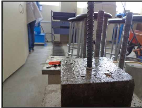
Figura 52. Preparación de la probeta prismática para la colocación de la parte superior
