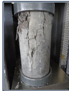
Fotografía 8.28: Cilindro ensayado a compresión
