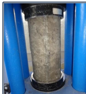
Fotografía 8.96: Rotura de cilindros a compresión en hormigón modificado
