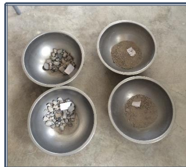
Fotografía 8.12: Muestras secas, lista para la obtención del contenido de humedad
