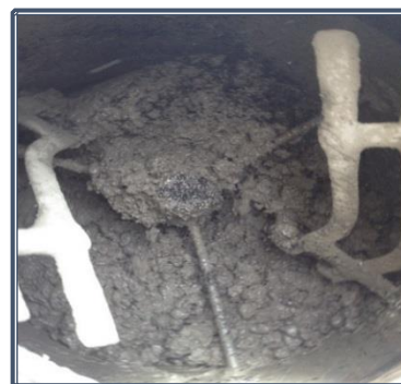
Fotografía 8.18: Mesclado del hormigón modificado
