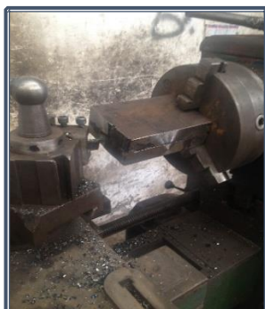
Fotografía 8.35: Creación del prototipo de adherencia hormigón-acero
