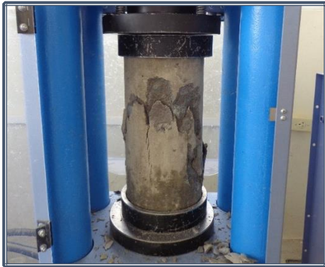
Fotografía 8.91: Rotura de cilindros a compresión en hormigón convencional
