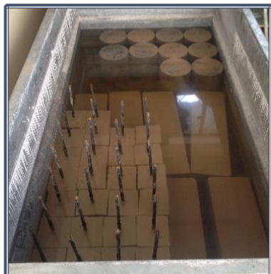
Fotografía 8.67: Curado final de probetas en general.
