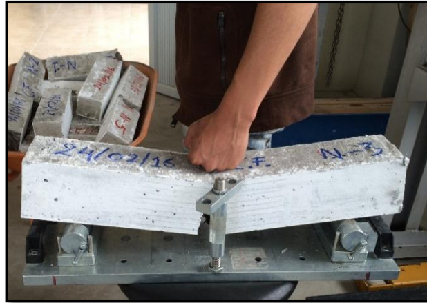
Figura 91. Separación de las partes de la viga de hormigón modificado
