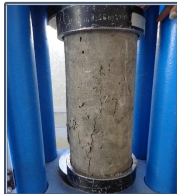
Fotografía 8.94: Rotura de cilindros a compresión en hormigón modificado
