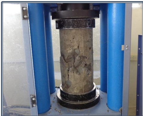
Fotografía 8.93: Rotura de cilindros a compresión en hormigón convencional
