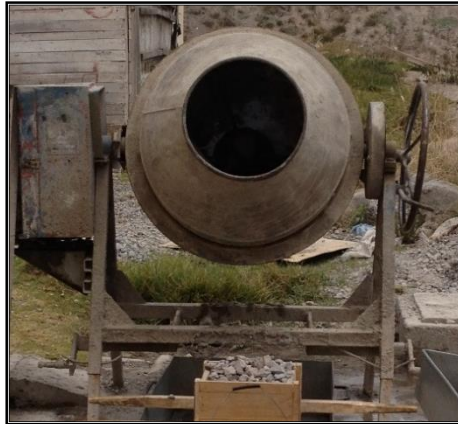
Figura 20. Humedecido de la concreteira antes de la mezcla de hormigón
