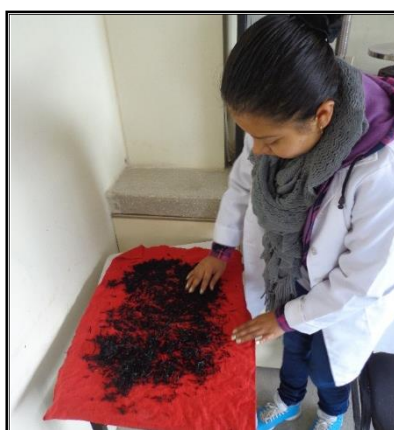
Figura 40. Poner sobre una franela las fibrillas recicladas de neumático
