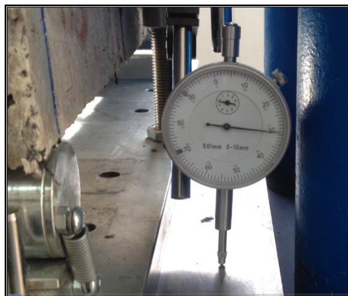
Figura 60. Cuantificación de la deformación en vigas.
