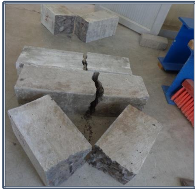
Fotografía 8.79: Vigas ensayadas, falla en los 2/3
