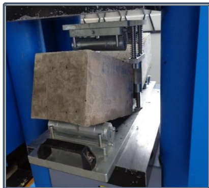
Fotografía 8.29: Viga simple con carga en los tercios, ensayada
