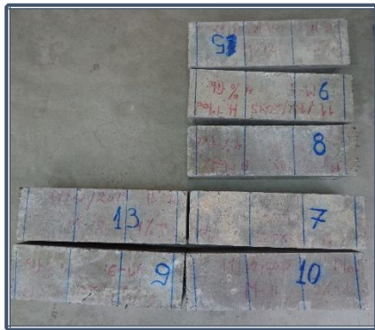
Fotografía 8.81: Vigas antes de ensayarse
