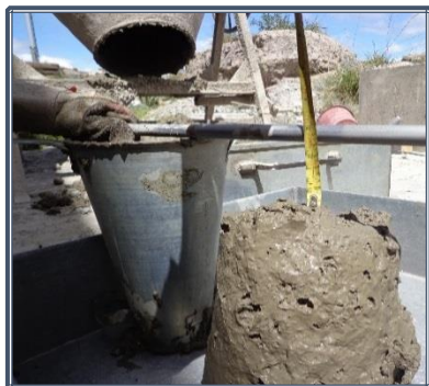
Fotografía 8.55: Medida de asentamiento
