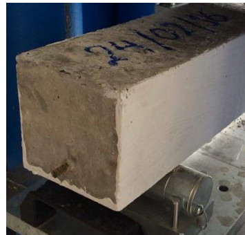
Figura 87. Probeta de concreto armado para ensayo a flexión
