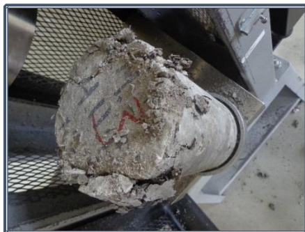
Fotografía 8.89: Cilindro de hormigón modificado con 4% de FRN
