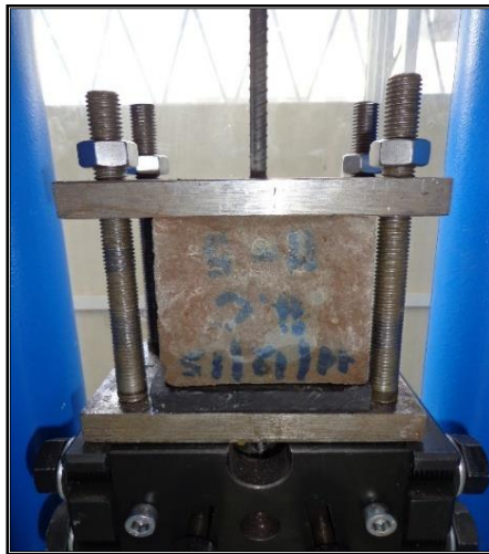
Figura 54. Ubicación del prototipo de adherencia en la maquina universal.
