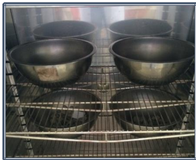
Fotografía 8.11: Muestras colocadas en el horno por 24 horas a temperatura de 110 \pm 5^{\circ}\text{C}
