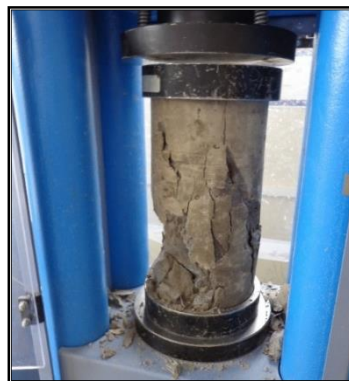
Figura 19. Falla del cilindro tipo III
