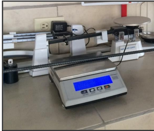
Figura 57. Registro del peso de un metro de una varilla de 10 mm.
