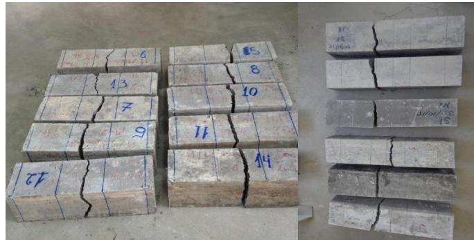
Figura 76. Ensayo realizado, flexión en vigas, izquierda hormigón convencional, derecho hormigón modificado
