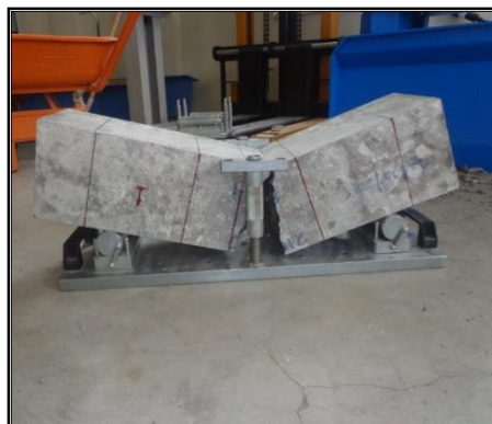
Figura 34. Probeta fallada, tipo de falla flexión dentro de los 2/3
