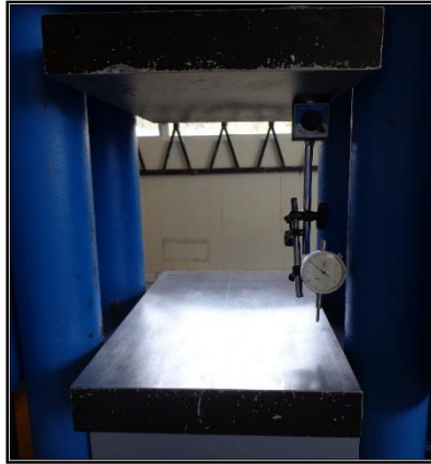
Figura 59. Colocación del deformímetro
