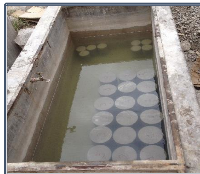
Fotografía 8.24: Ubicación de cilindros en la piscina de curado
