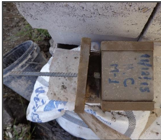
Figura 49. Desencoframos diligentemente todos los moldes de la probeta prismática.
