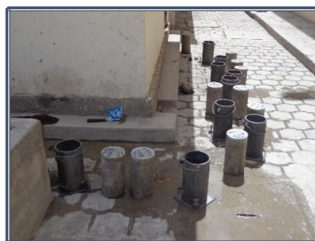
Fotografía 8.64: Desmolde de cilindros
