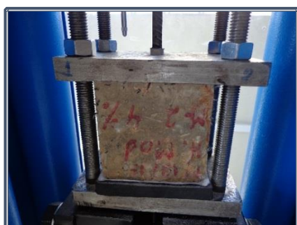
Fotografía 8.71: Colocación del cubo en la máquina de adherencia
