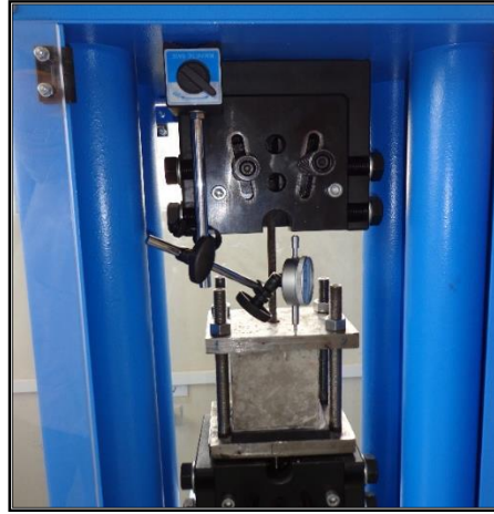
Figura 56. Ubicación del deformímetro para obtener su deformación
