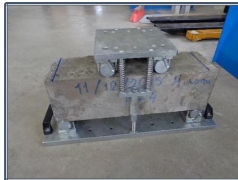
Fotografía 8.76: Colocación de la probeta a ensayar en la mesa a flexion
