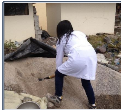
Fotografía 8.10: Recaudación de muestras para contenido de humedad (agregado fino)
