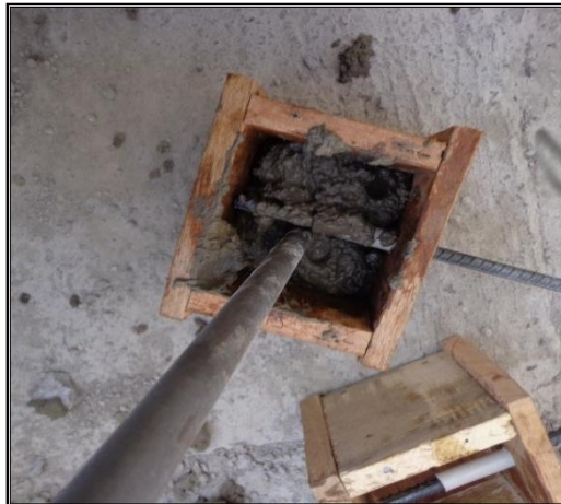
Figura 44. Varillado con 8 golpes por cada capa
