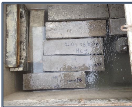
Fotografía 8.23: Ubicación de vigas en la piscina de curado
