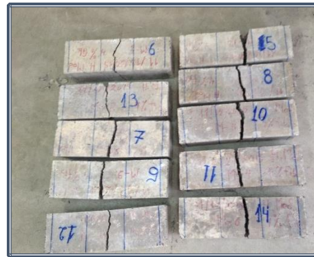
Fotografía 8.82: Vigas después de ensayarse (módulo de rotura)
