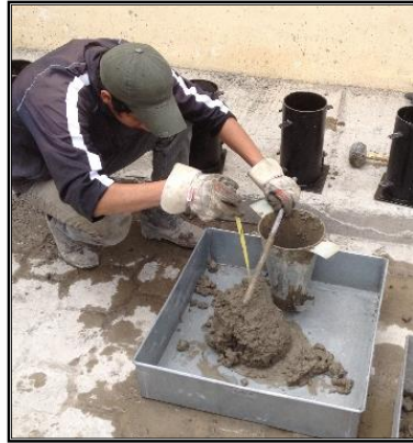
Figura 18. Control del revenimiento (asentamiento del hormigón estado fresco)
