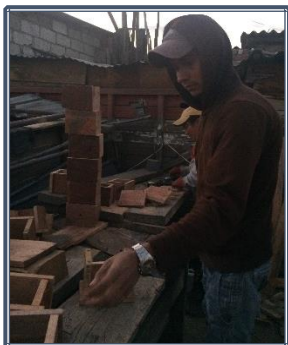
Fotografía 8.43: Elaboración de moldes para cubos de adherencia
