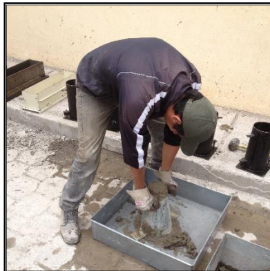
Figura 17. Retiro del molde (asentamiento del hormigón estado fresco)
