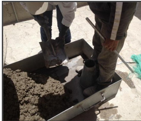
Figura 13. Cono de Abrams (asentamiento del hormigón estado fresco)
