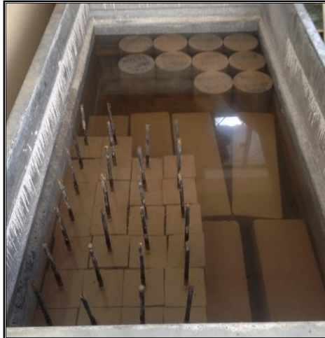
Figura 50. Curado final de las probetas prismáticas
