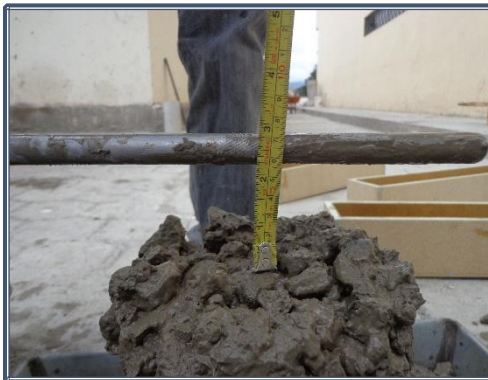
Fotografía 6.11: Asentamiento del hormigón modificado con FRN 5,7 cm
