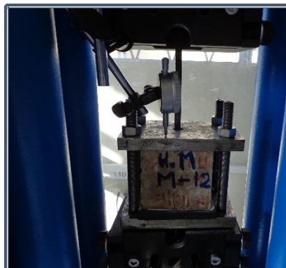
Fotografía 8.68: Ensayo de adherencia y medición del desprendimiento
