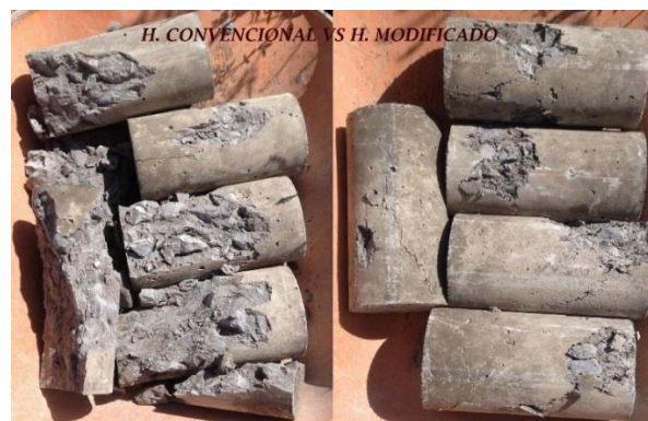
Figura 73. Ensayo realizado, compresión en cilindros, izquierda hormigón convencional, derecho hormigón modificado
