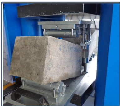
Fotografía 8.77: Falla de la muestra dentro de los 2/3 de la probeta
