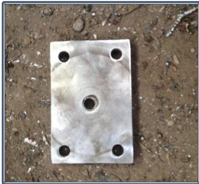
Fotografía 8.39: Pulido de placas para ensamble final
