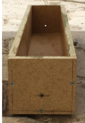
Figura 86. Orificios para colocación de la varilla
