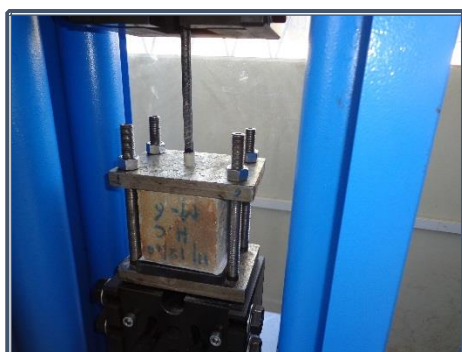
Fotografía 8.69: Probeta fallada por pull- out
