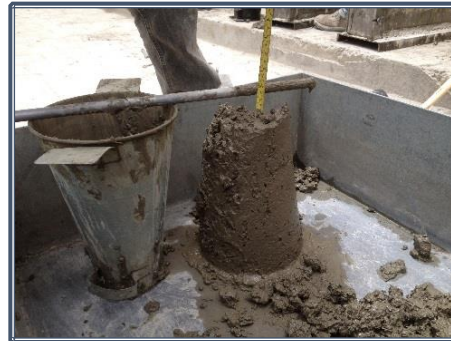
Fotografía 8.20: Control del asentamiento en hormigón convencional
