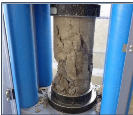
Fotografía 8.95: Rotura de cilindros a compresión en hormigón convencional
