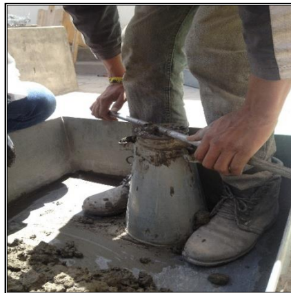
Figura 15. Enrasado con varilla de apisonado (asentamiento del hormigón estado fresco)
