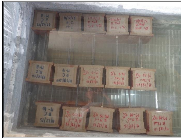
Figura 48. Identificación, almacenamiento y curado inicial.
