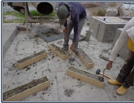
Fotografía 6.7: Vertido, varillado y compactado del hormigón convencional en los moldes
