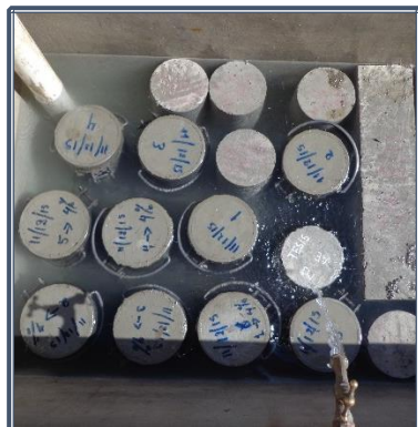
Fotografía 8.61: Curado inicial de cilindros de hormigón con y sin FRN
