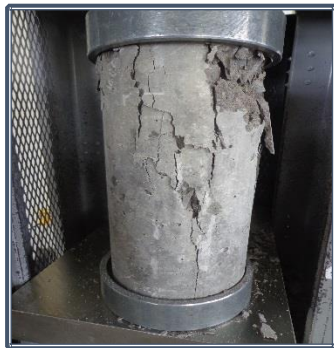
Fotografía 8.87: Falla tipo III
