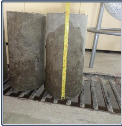
Fotografía 8.85: Toma de la altura en cilindros
