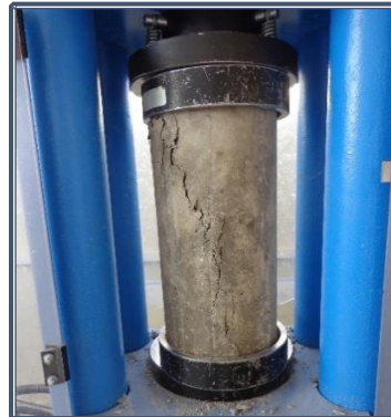
Fotografía 8.92: Rotura de cilindros a compresión en hormigón modificado
