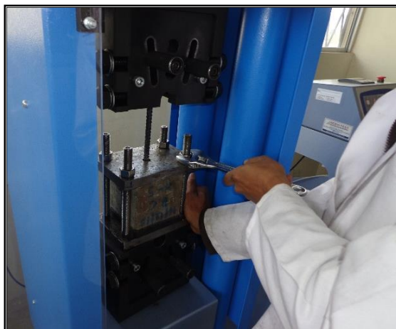
Figura 55. Ajustado fuertemente las tuercas con los pernos.
