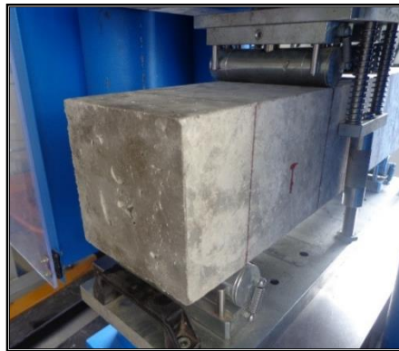
Figura 33. Ensayo de viga con la aplicación de carga a los 2/3
