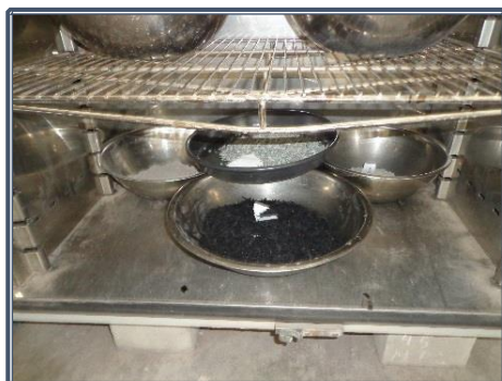
Fotografía 8.47: Control de humedad, agregado fino, grueso y FRN
