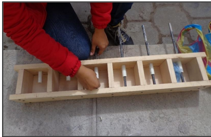
Figura 43. Ubicación de la varilla dentro de la probeta
