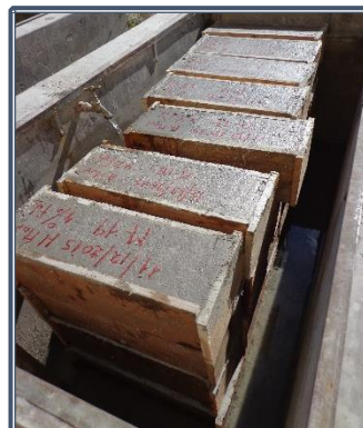
Fotografía 8.62: Curado inicial de vigas de hormigón con y sin FRN
