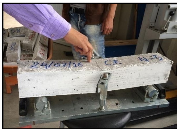
Figura 90. Viga de hormigón modificado f'_c = 210 \text{ kg/cm}^2 llevada a la rotura
