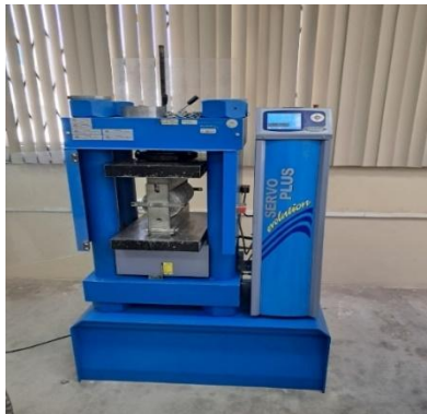
Fig. 44. Colocación del cilindro en máquina de ensayo.
