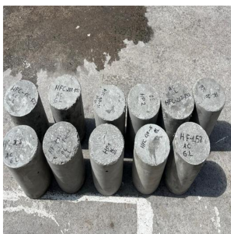
Fig. 28. Desmoldado de probetas.
