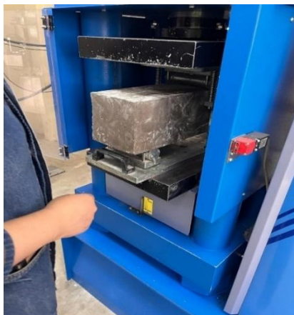
Fig. 41. Colocación de viga en máquina de ensayo.
