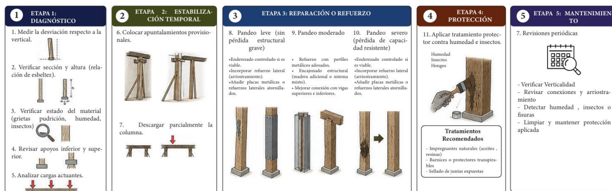
Ilustración 41 intervención en las columnas de madera o con pandeo Fuente: Elaboración Propia
