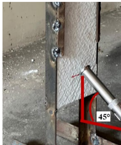
Figura 8 Colocación del mechero a 45° a una distancia de 0.5 cm
