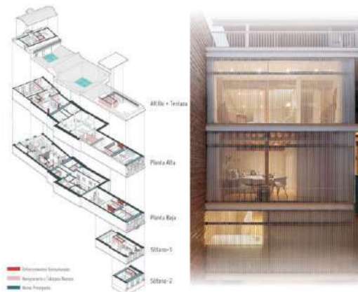
Figura 15. Análisis isométrico explotado del referente casa larga.
