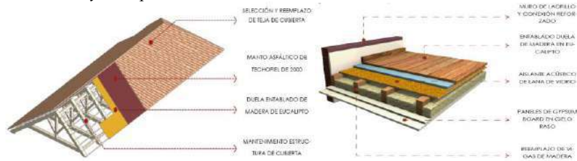
Figura 51. Intervenciones en cubierta y entresijos,
