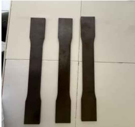
A 16. Probetas metálicas adicionales para ensayo de tracción.
