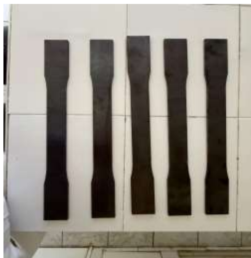
A 15. Probetas metálicas para ensayo de tracción.
