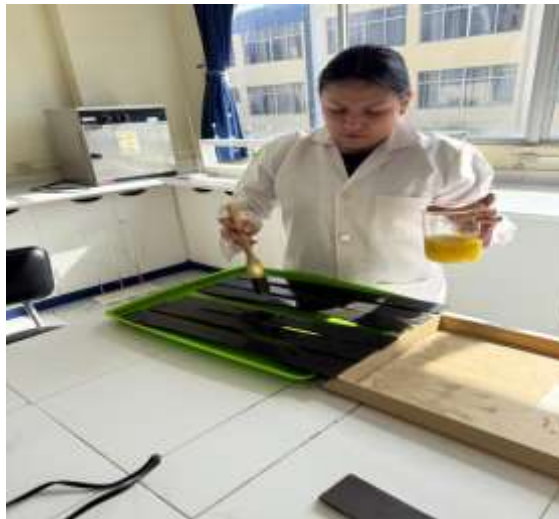
A 17. Aplicación superficial del inhibidor sobre placas metálicas.
