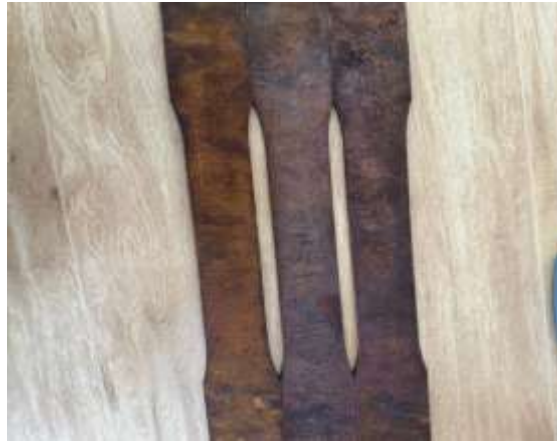
A 19. Probetas corroidas tras exposición al medio ácido.
