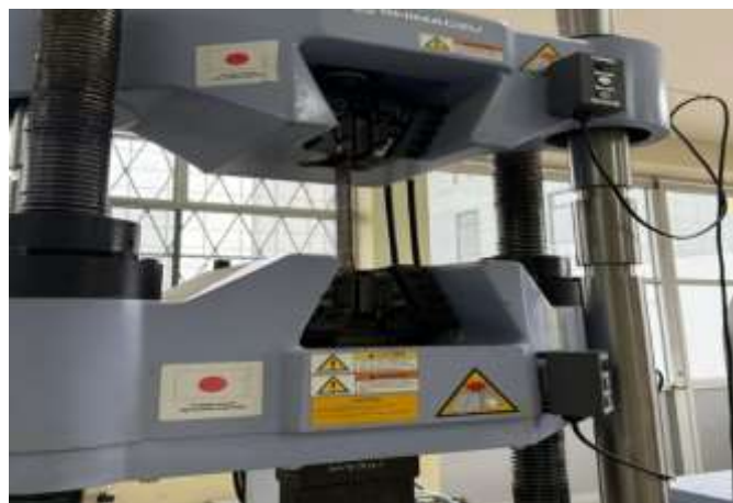
A 18. Máquina universal Shimadzu utilizada en los ensayos de tracción.
