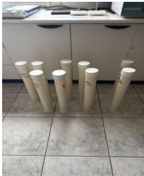
A 14. Probetas verticales con solución HCl 0.5 M.
