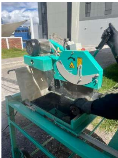
Figura 14: Corte del núcleo transversalmente.
