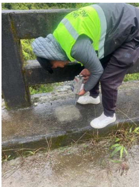
Figura 13: Ensayo con el esclerómetro, ángulo de 90^\circ .
