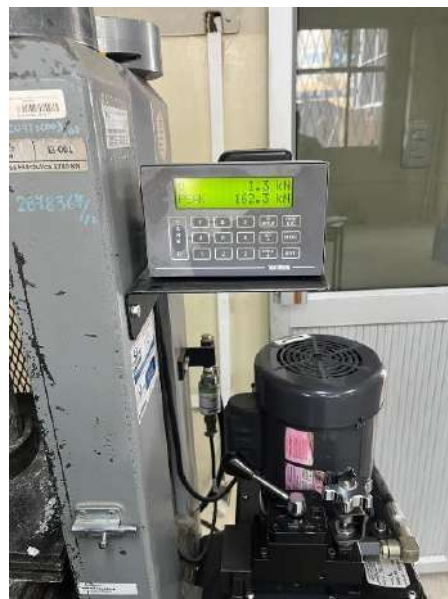
Figura 47: Resistencia a compresión de los cilindros.
