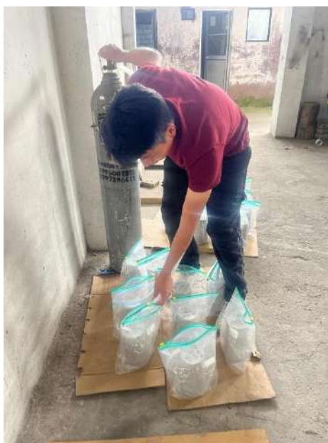
Figura 43: Inyección diaria del CO 2 en las fundas de polietileno con cierre hermético.
