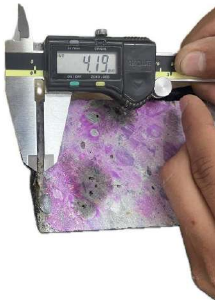
Figura 16: Medición de profundidad de carbonatación con la fenolftaleína con el pie de rey.
