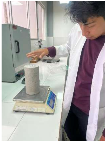
Figura 45: Peso y dimensión de los núcleos.
