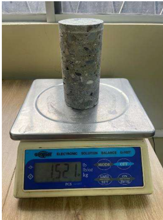
Figura 17: Peso y dimensión de los núcleos.
