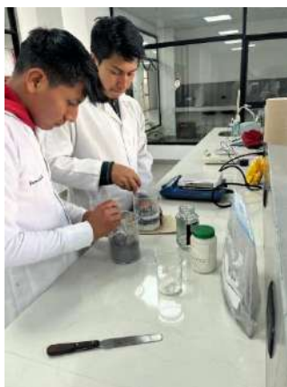
Figura 39: Mezcla de la sílice, maicena y silicato de sodio a 5°.
