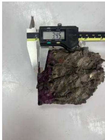
Figura 44: Medición de profundidad de carbonatación con la fenolftaleína con el pie de rey.
