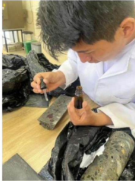
Figura 15: Colocación de la fenolftaleína.
