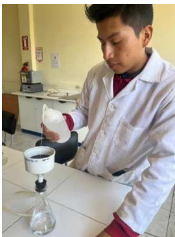
Figura 35: Extracción del ácido clorhídrico con el agua destilada en la maquina extractora de vacíos.
