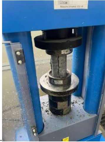
Figura 20: Rotura de los núcleos.
