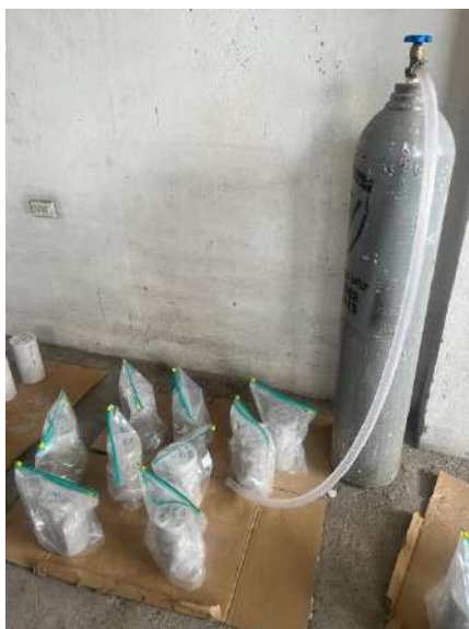
Figura 42: Fundas de polietileno con cierre hermético y tanque de CO 2 .
