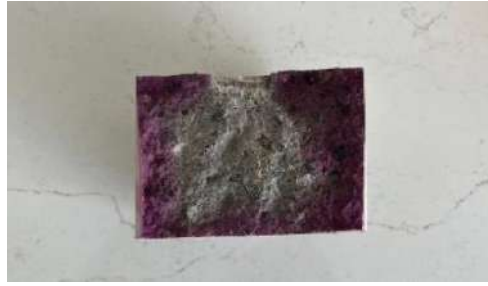
Figura 41: Ensayo de prueba con la fenolftaleína.
