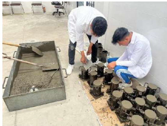
Figura 27: Llenado de los moldes.
