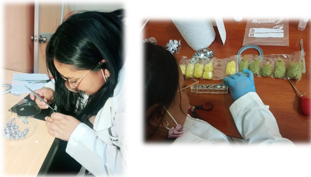
Figura 26 Preparación de la Fibra para microscopia de barrido SEM
