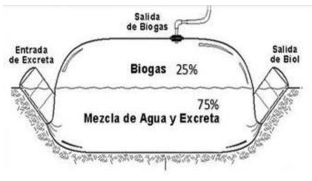
Figura 10. Porcentaje de gas en la cámara de fermentación.
