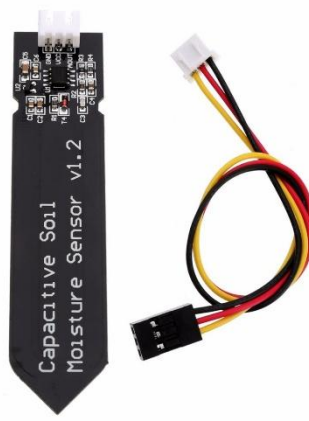
Figura 22. Sensor del suelo capacitivo V1.2 [45].
