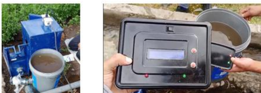
Figura 36. Calibración de sensores de caudal
