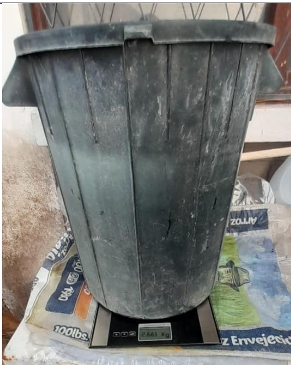
Fotografía 7: Pesaje de las muestras para la PPC.
