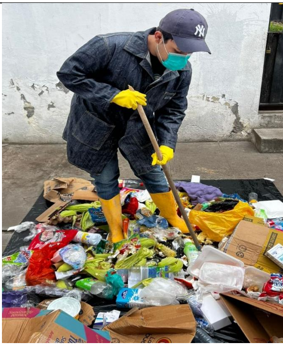
Fotografía 8: Homogenización de RSU
