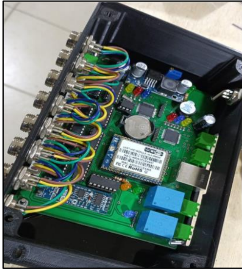
Figura 36. Vista del circuito central montado en caja impresa en 3D
