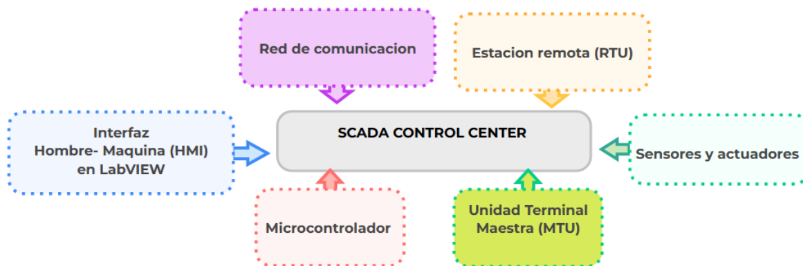
Figura 5. Sistema SCADA [Autor]
