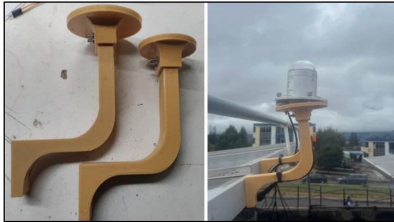
Figura 38. Soporte y ubicación de los sensores de UV e irradiancia
