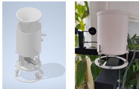
*Ilustración 22. Diseño y ejecución del sistema de precipitación*
