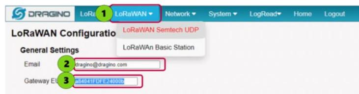
**Ilustración 33.** Configurando el UEI del Gateway para la transmitir datos.
