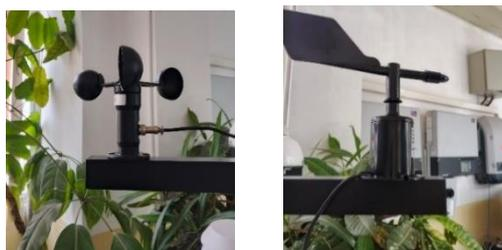
*Ilustración 21. Diseño y ejecución de sensores de velocidad y dirección del viento*
