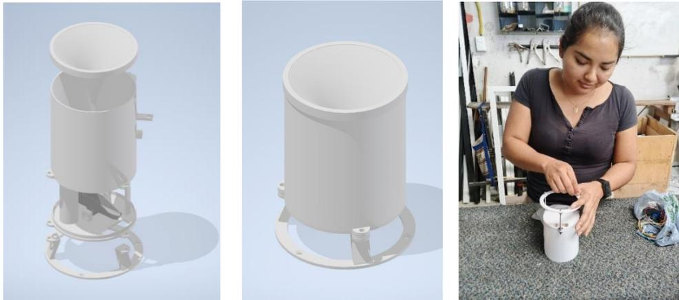
**Ilustración 56.** Diseño y Ensamblaje 3D del sistema de precipitación
