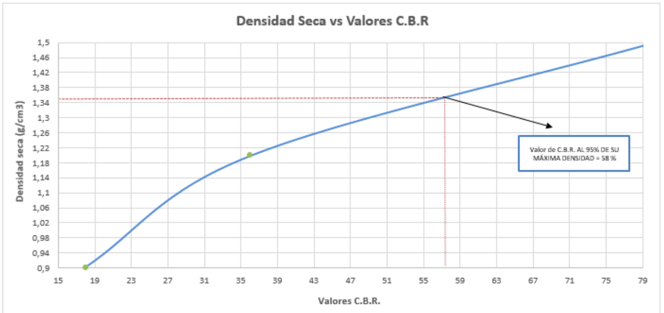
Gráfico 21. Densidad seca vs Valores C.B.R
