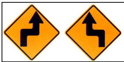
Figura 53. Curva y contra curva peligrosas (derecha-izquierda); y, curva y contra curva peligrosa (izquierda-derecha).
