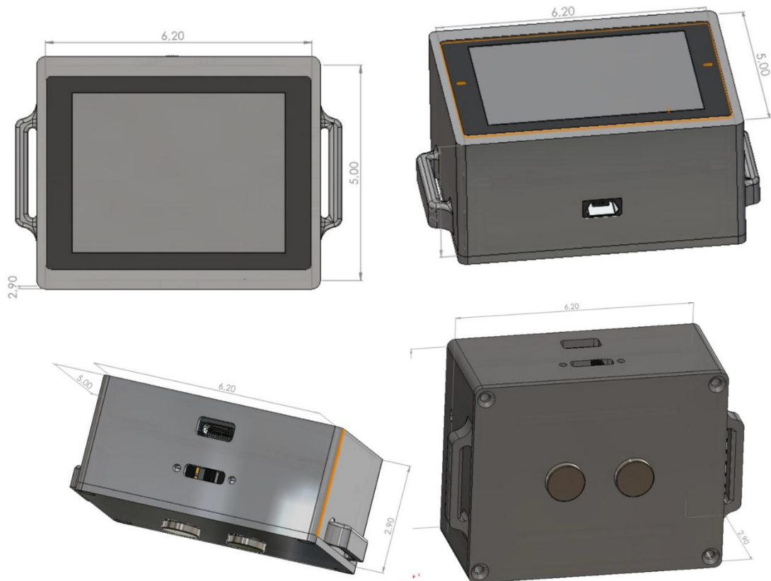
Figura 12. Diseño del armazón del dispositivo; parte frontal, lateral y trasera con sus respectivas medidas en cm.
