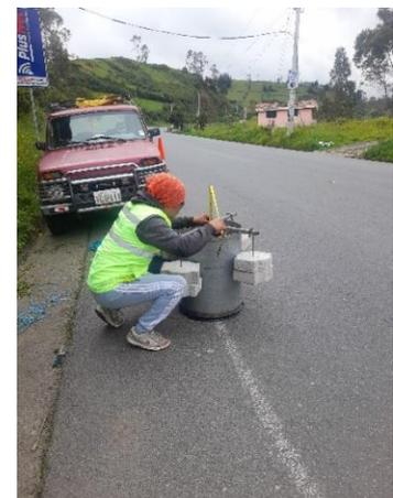
**Anexo 18.** *Toma de datos en campo del Infiltrómetro.*
