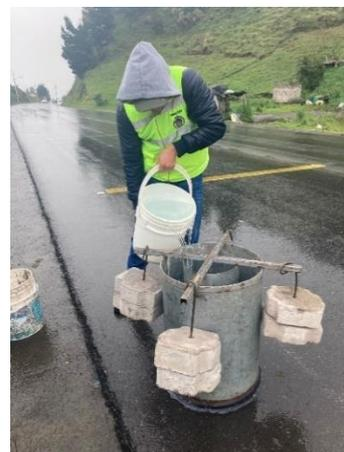
**Anexo 17.** *Ensayo Infiltrómetro.*
