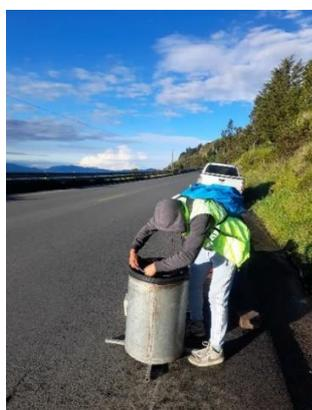
**Ilustración 11.** *Colocación del caucho en el infiltrómetro.*
