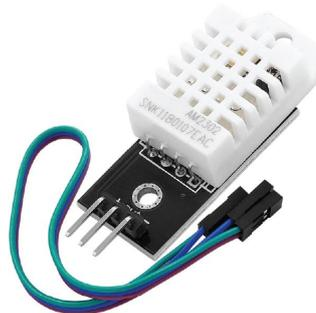
**Figura 11.** Sensor de humedad y temperatura DHT22 [26]
