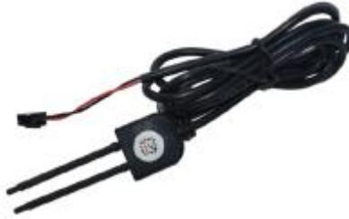
**Figura 10.** Sensor de humedad FC-38 [24]
