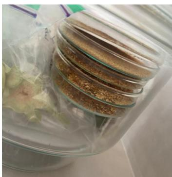
Placas de Petri con muestras de semillas de amaranto almacenadas dentro de un desecador. Este paso es fundamental para mantener las muestras secas y evitar la absorción de humedad del ambiente antes de realizar pesadas u otros análisis. También pueden contener muestras previamente secadas en estufa para determinaciones de humedad o conservación.
