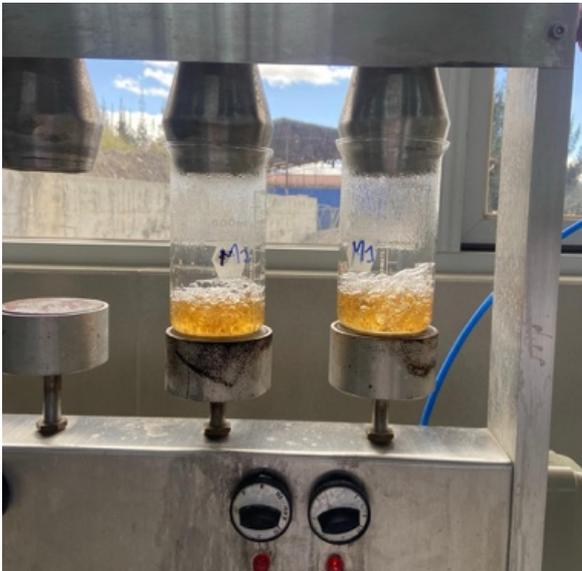
Equipo de digestión donde la muestra es sometida a condiciones controladas para eliminar componentes solubles
