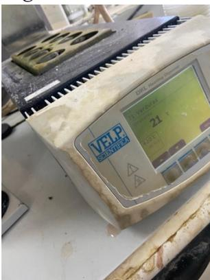
Utilizado principalmente para la digestión de muestras orgánicas en el análisis de nitrógeno por el método Kjeldahl, con una temperatura de trabajo inicial de 21 °C. Este digestor permite una digestión homogénea y simultánea de múltiples muestras, asegurando eficiencia en los procesos de preparación de muestra para análisis de proteína.
