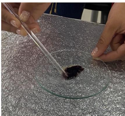
Se observa la ejecución de la prueba cualitativa de almidón en una cápsula de Petri. Mediante la adición de una solución de yodo, se evidencia la presencia de almidón por la formación de un complejo de color azul oscuro o morado intenso, característico de esta interacción.
