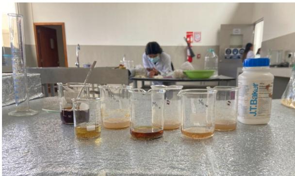
Las muestras identificadas como M1, M2 y M3 corresponden a los distintos sustratos utilizados durante la germinación del amaranto. Este análisis se basa en el método gravimétrico posterior a la digestión química
