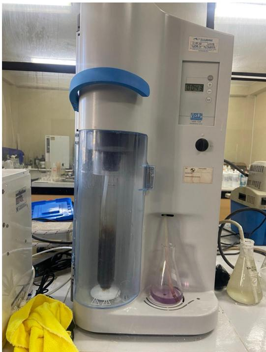
Es un procedimiento estándar en análisis de alimentos. Este método se basa en la cuantificación del nitrógeno total presente, el cual se multiplica por un factor (generalmente 6.25) para obtener el porcentaje de proteína.
