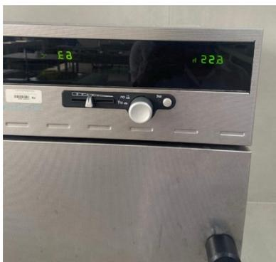
Estufa de secado a 63 °C con un temporizador de 6.55 horas. Este equipo se utiliza comúnmente para la determinación de humedad en alimentos. Las muestras se mantienen a temperatura constante durante varias horas para eliminar el contenido de agua, permitiendo así calcular la pérdida de peso por deshidratación.
