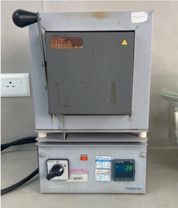
Utilizada para la determinación del contenido de cenizas en las muestras de amaranto germinado y no germinado. Este equipo permite alcanzar altas temperaturas (generalmente 500–600 °C) para incinerar el material orgánico y obtener el residuo inorgánico. En el display se visualiza la temperatura alcanzada durante el proceso. La mufla es un equipo esencial en análisis gravimétricos para la caracterización fisicoquímica de alimentos.
