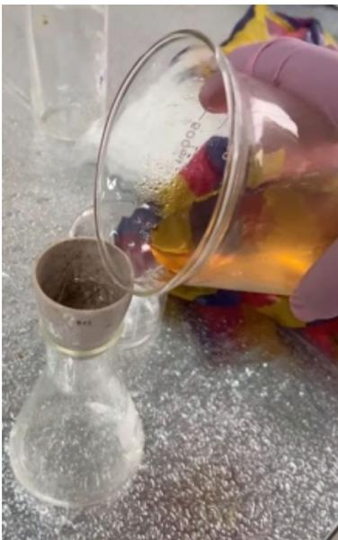
Proceso de separación de la fracción no digerida en el análisis de fibra cruda. Se transfiere cuidadosamente la muestra desde un vaso de precipitado hacia un crisol con papel filtro, con el fin de retener los residuos insolubles (fibra). Este paso es esencial para su posterior secado, calcinación y pesada, permitiendo cuantificar con precisión el contenido de fibra dietética.
