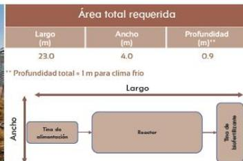
Figura 142. Área Biodigestor, 2024
