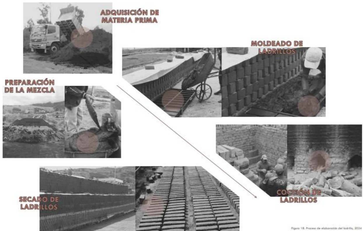
Figura 18. Proceso de elaboración del ladrillo, 2024
