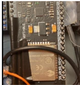
Figura 24. ESP32 y sus respectivas conexiones.
