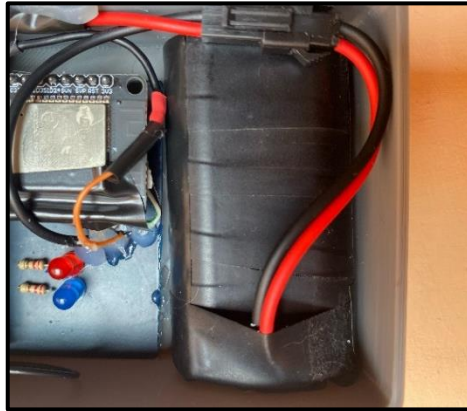
Figura 23. Bloque de alimentación del receptor.
