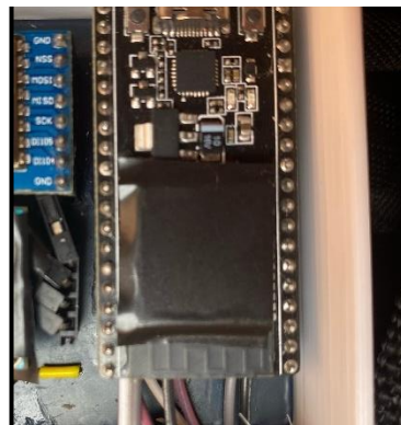
Figura 20. ESP32 y sus respectivas conexiones.
