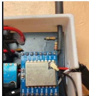
Figura 22. Módulo LoRa utilizado para el envío de datos.
