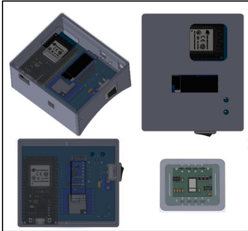
Figura 12. Ensamble del dispositivo Transmisor y Gateway.
