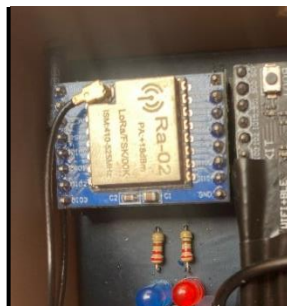
Figura 25. Módulo LoRa utilizado para la recepción de datos.
