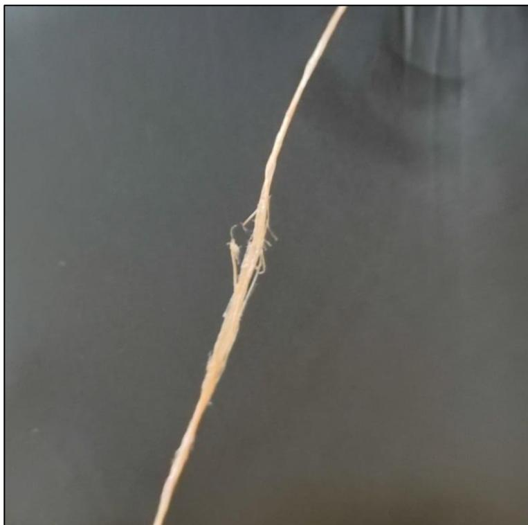
50. Detalle de la ruptura del hilo sintético
