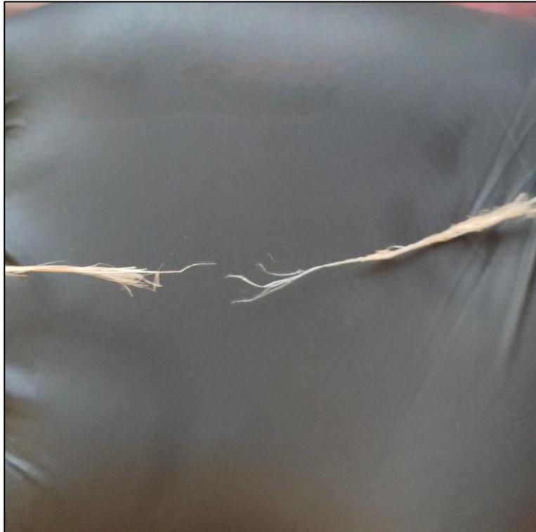
53. Detalle de la ruptura del hilo de chambira encerado
