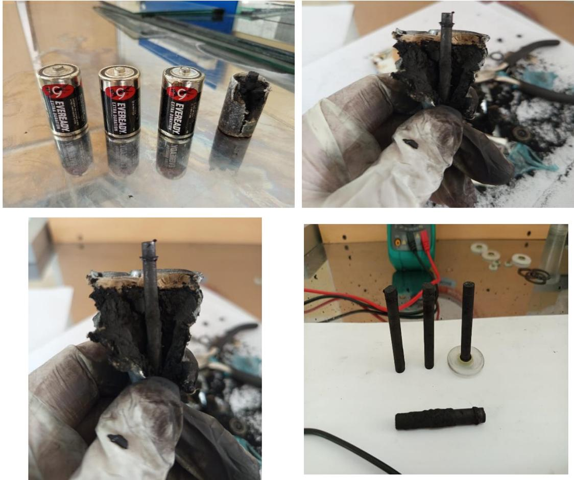
**Nota.** Para la extracción de las barras de grafito se precisó de pinzas y alicates para separar y limpiar el resto de las partes que componen una batería de este tipo.
