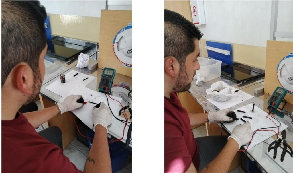
**Nota.** Un pitido de baja intensidad proveniente del multímetro señala la correcta conductividad del electrodo, asegurando la transmisión de energía.
