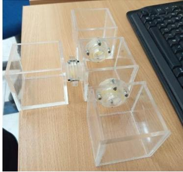
**Nota.** La imagen ilustra el armado estructural de la CCM-TA con la MIP en el diafragma que conecta el cátodo con los ánodos.
