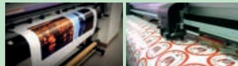
Un plotter de impresión es una impresora especializada en imprimir diseños de gran formato con alta precisión.
