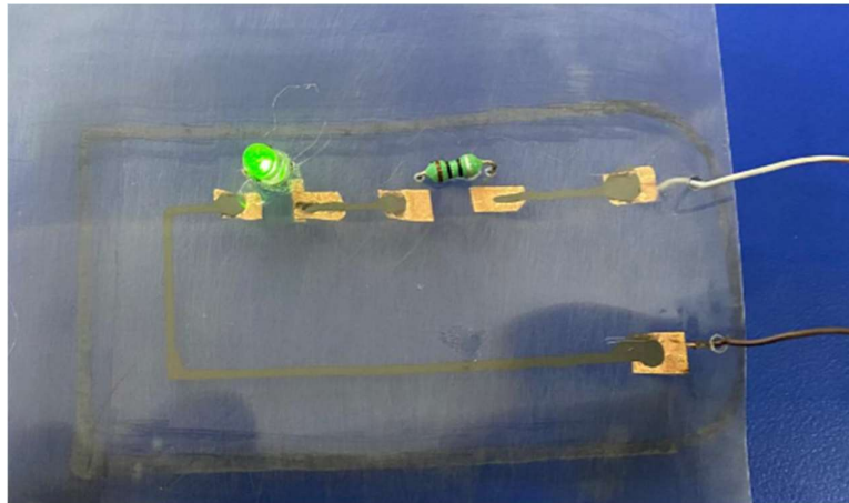
Figura 4. 40. Funcionamiento del circuito impreso con tintas conductivas. (Autor)
