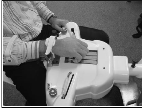
Figura 7: Robot Amadeo con los dedos en flexión Fuente: [35]
