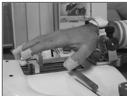
Figura 6: Robot Amadeo mostrando la unión de los dedos al dispositivo Fuente: [35]
