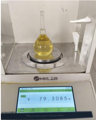
Figura 12. Peso del picnómetro con la muestra del aceite de palma.
