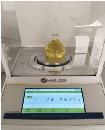
Figura 13. Peso del picnómetro con la muestra del aceite de girasol.
