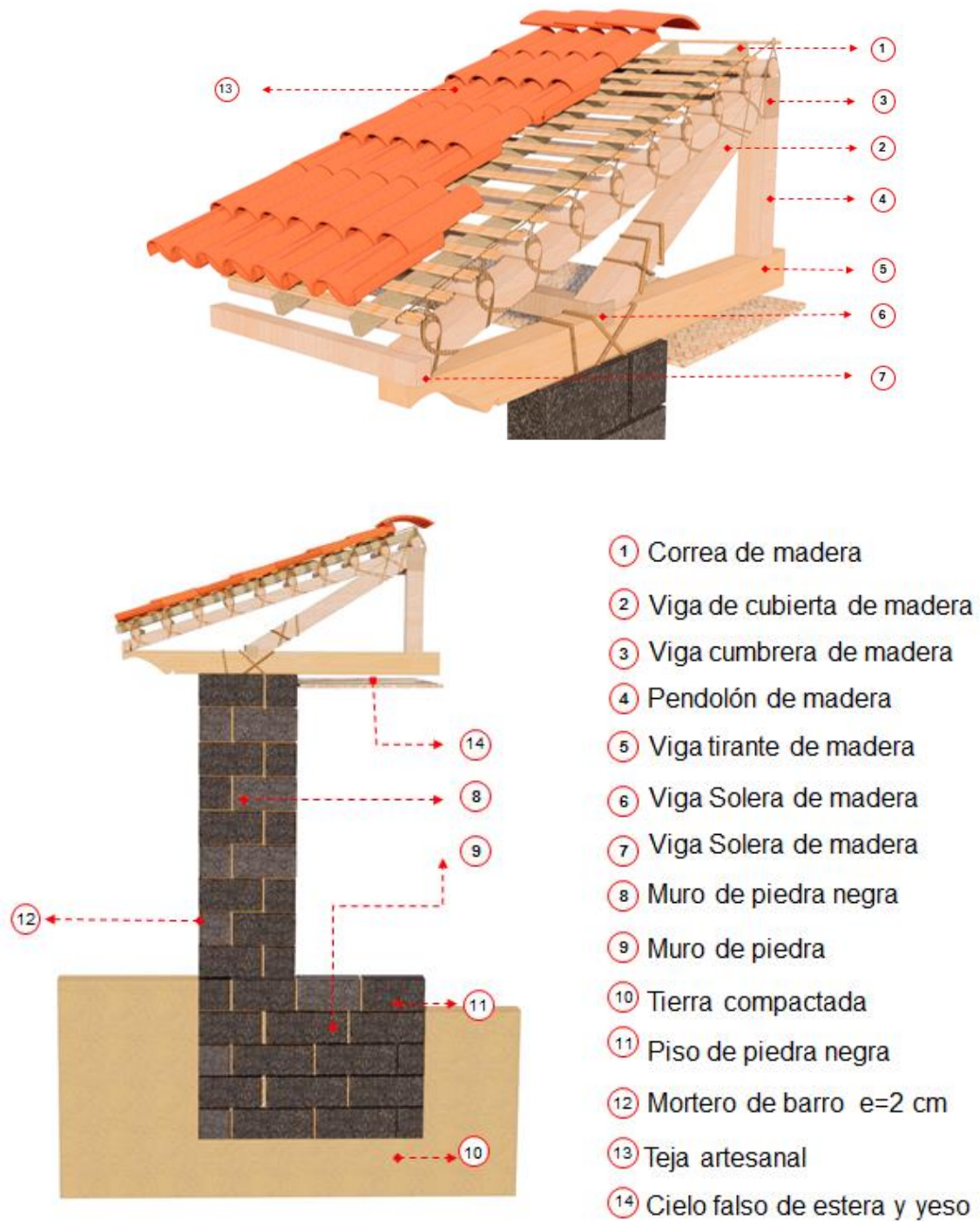
Ilustración 16. Landy Sandra. (San Andrés, 2023). Detalle en corte de vivienda tipo
