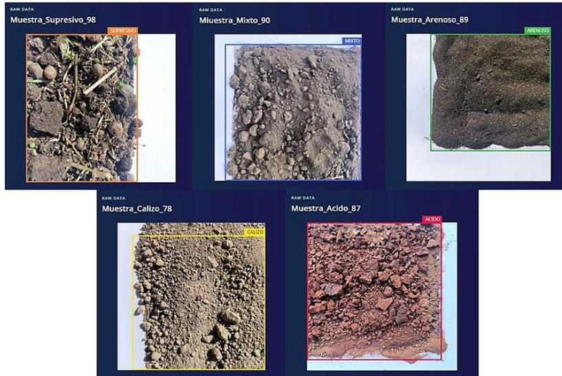
*Ilustración 54.- Etiquetado manual de datos para el entrenamiento de la IA en el sistema “Detección de texturas”.*
