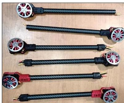
*Ilustración 10.- Ensamblaje de motores y brazos del hexacóptero.*
