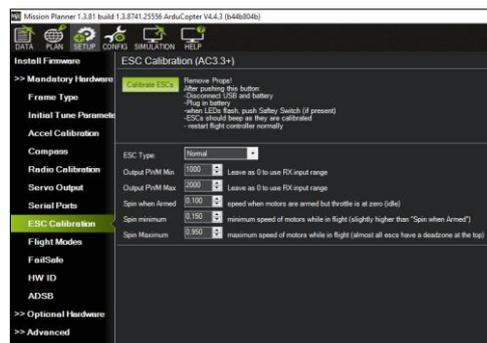
*Ilustración 31.- Calibración y parámetros de ESC utilizada en el dron.*
