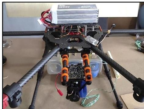
*Ilustración 18.- Acoplamiento de la batería en el dron.*
