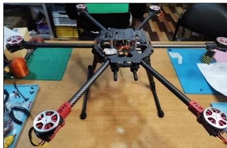
*Ilustración 13.- Incorporación de los motores y ESC 40A al Frame.*
