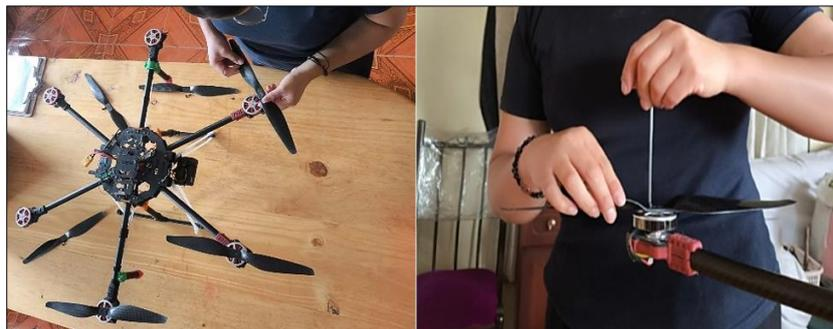
*Ilustración 19.- Colocación de las hélices en el dron.*
