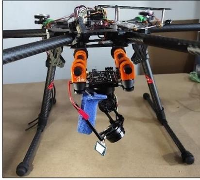
*Ilustración 14.- Acople del gimbal y la cámara.*
