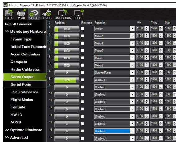
*Ilustración 29.- Configuración de salida de motores y actuadores en el dron.*
