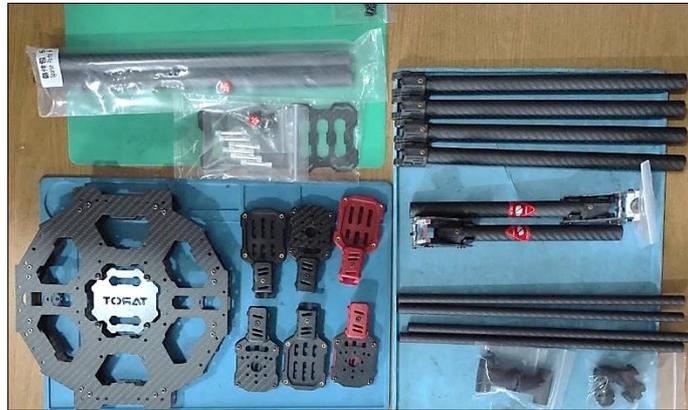
*Ilustración 8.- Componentes de la estructura Frame 680*
