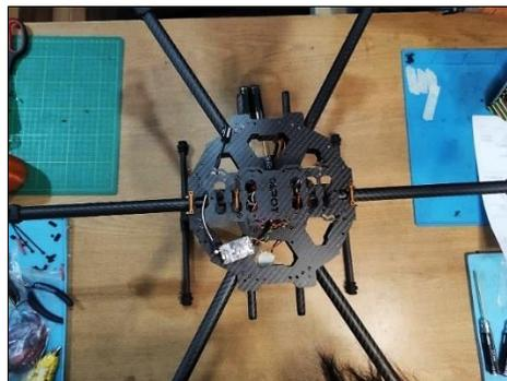
*Ilustración 9.- Chasis Frame 680 ensamblado.*
