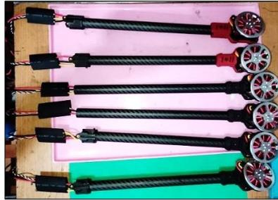
*Ilustración 11.- Conexiones entre motores y ESC.*
