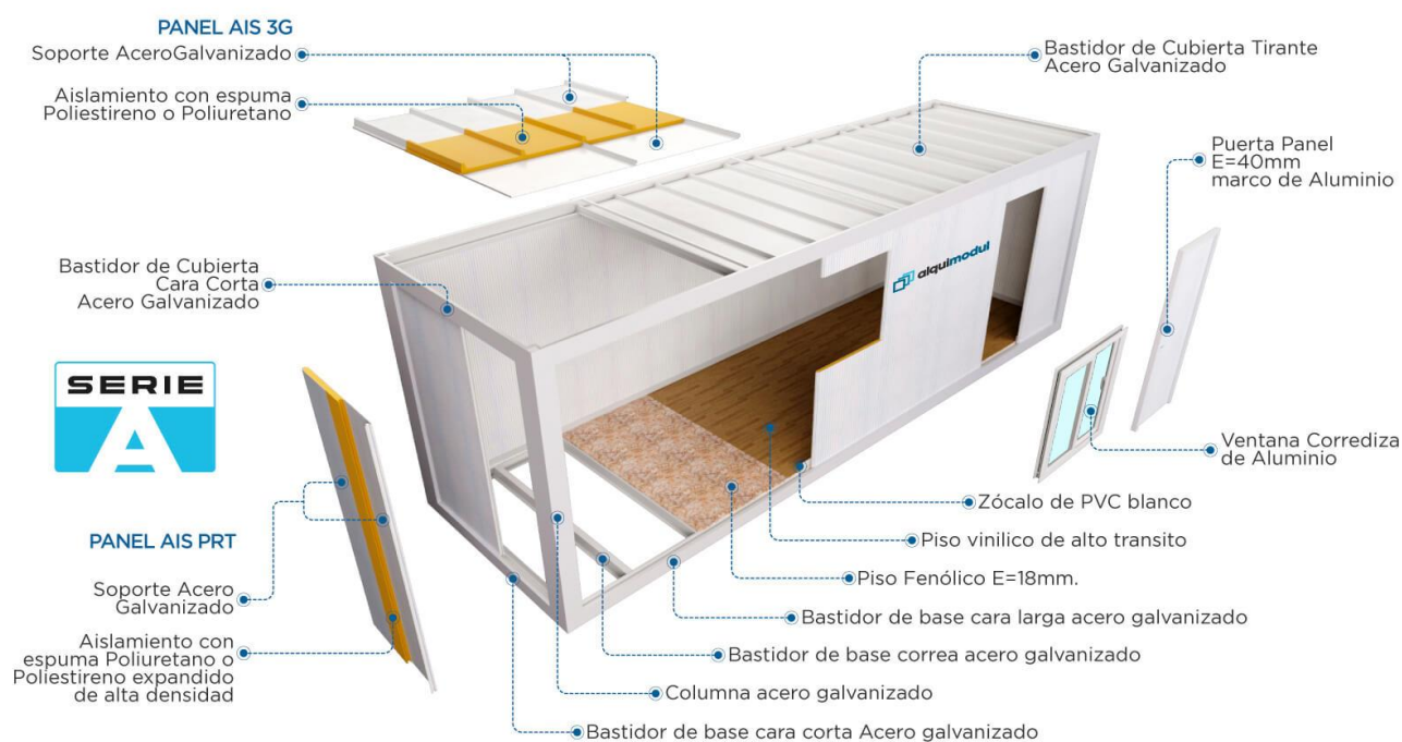
Figura 20. Perspectiva Explotada de un Contenedor Habitable
