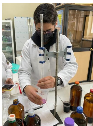
Figura 24. Titulación de muestras activadas
