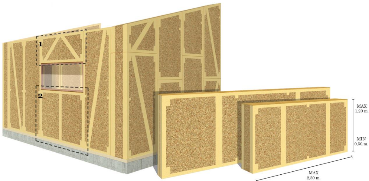
Figura 20: Dinteles y antepechos prefabricados - alfaWALL
