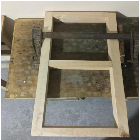
Figura 37. Proceso de armado de escalerillas.
