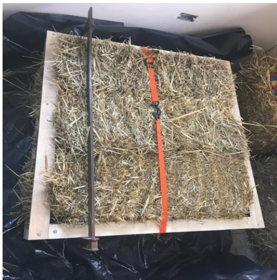
Figura 42: Prensa manual de compresión. Fuente: (Sagñay, 2024)
